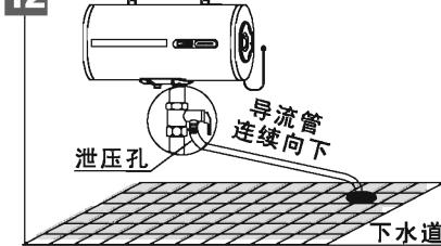
**注意：泄压安全阀与导流管均应安装在无霜环境下；严禁堵塞、扭曲，并保持与大气相通。**
