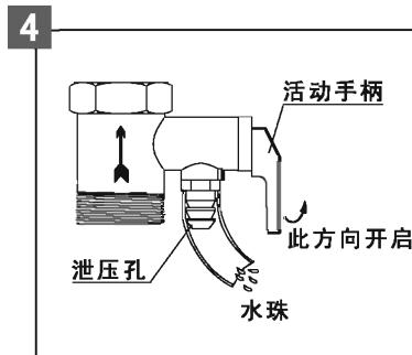
**注意：泄压安全阀活动手柄要定期开启，开启时要关闭热水器热水出口，保持进水口通畅，让自来水从泄压孔中排出，冲洗泄压水流通道，以防止水垢沉积堵塞。**
